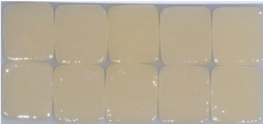
Abb. 17: Vita Mark II nach einwöchiger Einlage in der jeweils oberhalb notierten Lösung
