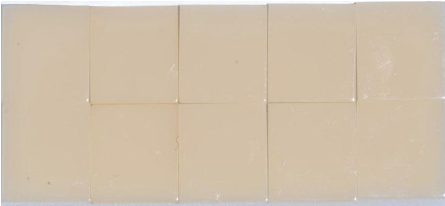
Abb. 11: Shofu Block HC nach einwöchiger Einlage in der jeweils oberhalb notierten Lösung
