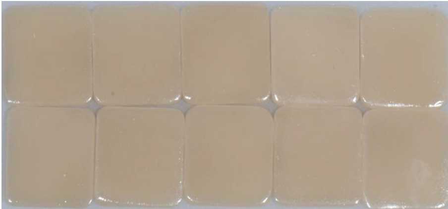
Abb. 14: IPS e.max CAD Blocs vor Einlage in Testlösungen
