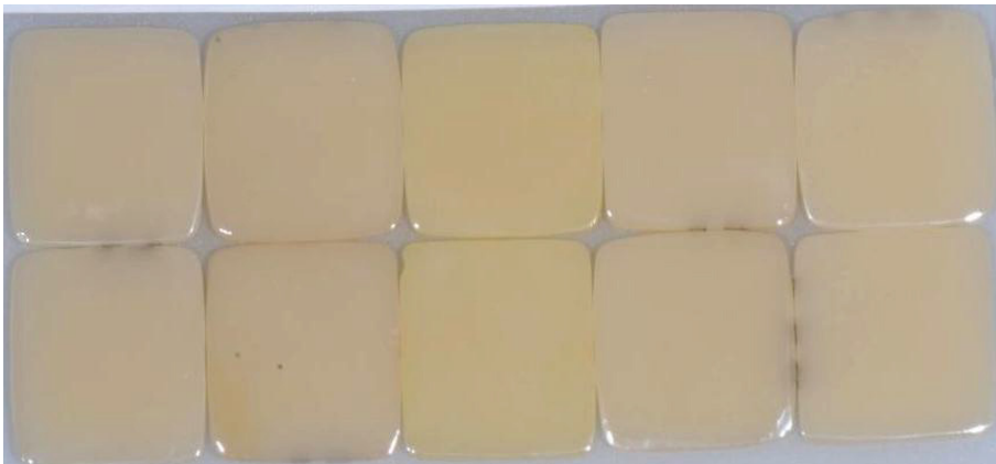
Abb. 13: Lava Ultimate nach einwöchiger Einlage in der jeweils oberhalb notierten Lösung
